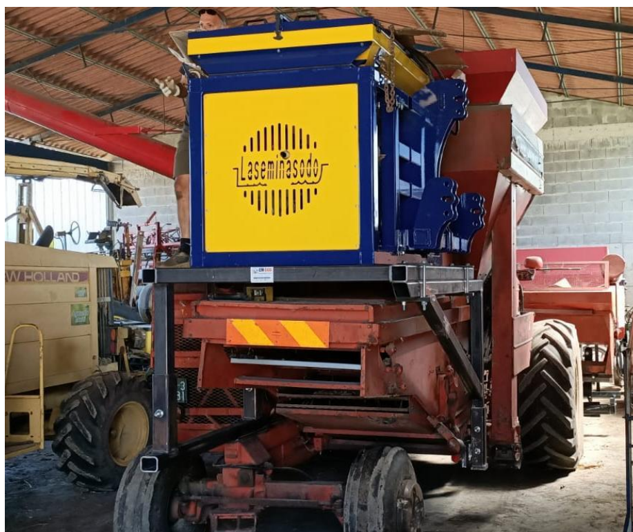
Seminatrice su mietitrebbia; telaio di sostegno a tubolari quadri
